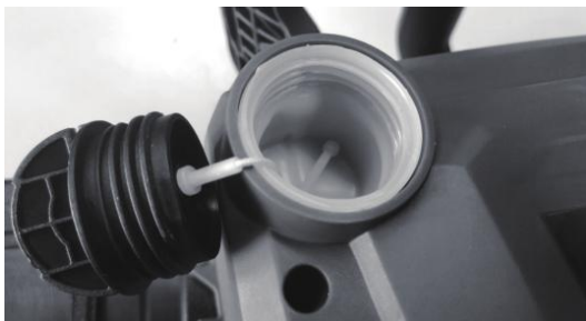
Tampa e abertura do depósito de óleo da corrente.
